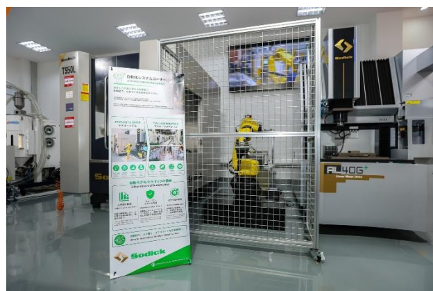
形彫り放電加工機「AL40G+」と多関節ロボットによる自動 化システム
