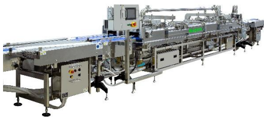
連続式真空冷却装置
