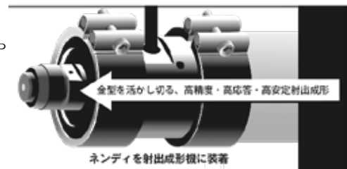
溶融せん断粘度測定装置「Nendy-E(ネンディ)」(イメージ図)
