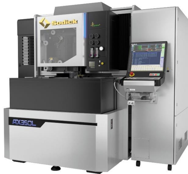
リニアモータ駆動 超精密ワイヤ放電加工機「AX350L i Groove + Edition」
