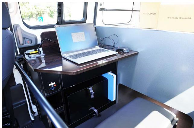
運転席の後ろにあるリモートオフィス空間。作業机の下に専用バッテリーを設置し、快適に業務を行うことが可能。
