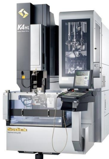
K4HL 外観: AEF-C、ATC、LGC、2軸ロータリワークテーブル、測定プローブオプション仕様付き
