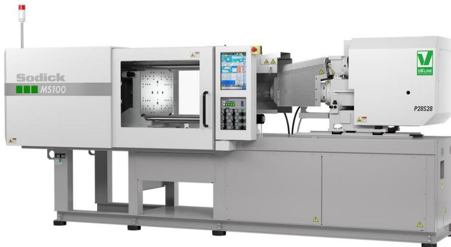
INFILT-V システム搭載 eV-LINE 電動射出成形機 MS100 外観
