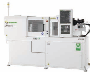
高精度射出成形機「LP20EH4」
