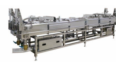
連続式真空冷却装置。2つの冷却室で交互に真空冷却することで連続処理が可能。短時間で食品を冷却し、菌の増殖と食味の劣化を抑制
