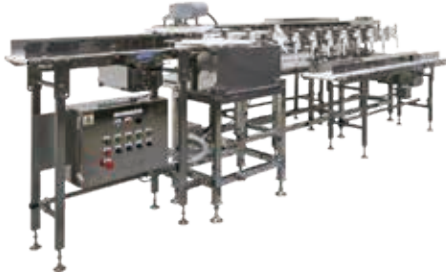
上向きトレイ脱パン装置 具材が載った状態で冷凍された食品を、冷凍用の容器から排出する装置。具材の載っている表向きで容器から排出することで、具材の欠落ロスを無くしたほか、省人化と、異物混入リスクを解消
