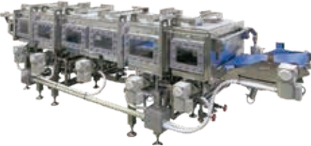
並列する2カ所の冷却室を交互に真空冷却する「連続式真空冷却装置」。短時間で食品を冷却させることで、菌の増殖と食味の劣化を抑制
