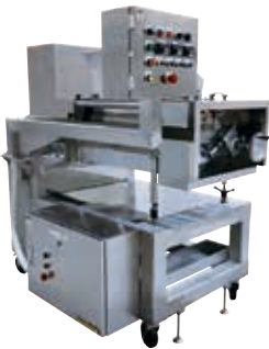
スリーロールシーター 多加水で粘弾性のある麺生地や菓子生地などを、3本のロールで丁寧に押し込むことにより帯状に形成する装置
