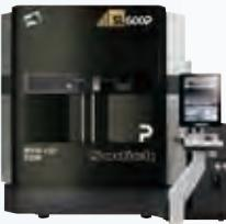
リニアモーター駆動高速・高性能ワイヤ放電加工機 SL600P
