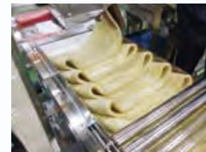
綾織り装置：麺帯を折り重ね、90度反転させて連続圧延しコシの強い麺帯が製造可能
