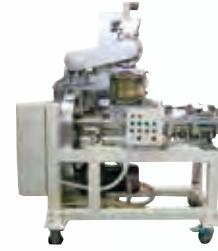
エクストルーダー：麺生地をスクリュウで押し出しながら真空引きし、脱気、高弾力の麺生地を作り出す装置
