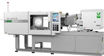
eV-LINE 射出成形機「MS100」は高精度成形で独自技術を培ってきたV-LINE®の基本性能をベースとしたエントリーモデルの全電動射出成形機です。可塑化・射出部分及び型締機構の両方にサーボモータを採用することで安定かつハイサイクルな成形が可能となります。また、新・操作パネルの採用により、見やすさを向上させ、更なる生産性向上と省エネ効果を実現しているのが大きな特徴です。
