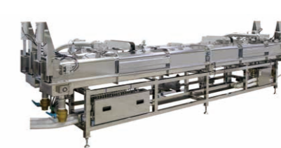
連続式真空冷却装置。2つの冷却室で交互に真空冷却することで連続処理が可能。短時間で食品を冷却し、菌の増殖と食味の劣化を抑制
