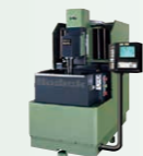
世界で初めて放電加工機にリニアモータを搭載「AM35L」
