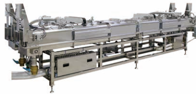
連続式真空冷却装置。2つの冷却室で交互に真空冷却することで連続処理が可能。短時間で食品を冷却し、菌の増殖と食味の劣化を抑制
