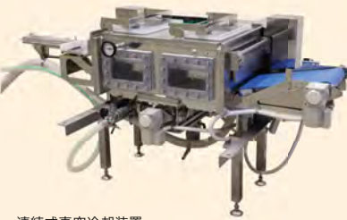
連続式真空冷却装置
