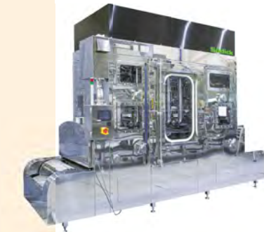
短時間型連続蒸気殺菌装置 ジェットノズルを用いて食材に殺菌用蒸気を効率的に噴射する装置。省エネかつ省スペース、重油の使用量も削減
