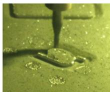
金属3Dプリンタの切削加工工程
