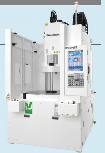
縦型ロータリー式射出成形機「TR40VRE2」
