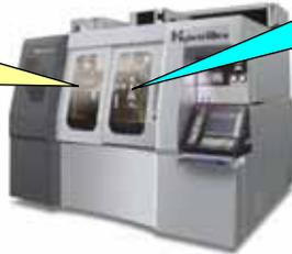
自動車部品生産業界など順送プレス金型製造において、下穴加工から精密仕上げまで、一台の加工機にて完全自動加工を実現
