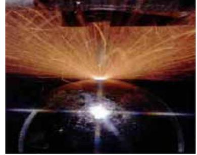
1マイクロ秒の間に1000A以上の高ピーク電流をばらつき無く発生させる。
