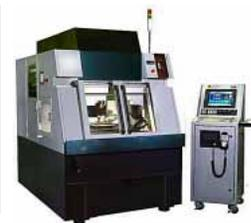
“SPACEシリーズ”とは、その最小駆動単位が1~5ナノメートル未満で、加工形状精度が5~100ナノメートル未満を可能とする、リニアモータ駆動 超高精度ナノ加工機群の総称です。
