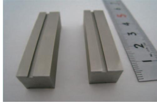
※ 加工データは、当社指定条件のもと、φ0.2mm ワイヤで厚さ 40mm の鉄鋼材を加工した際のデータです。
