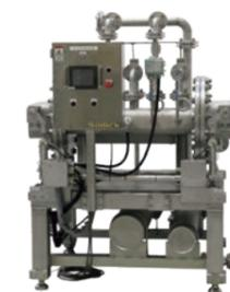
高温飽和水蒸気を利用して、食材表面をごく短時間で高度に殺菌する加圧加熱殺菌装置などで、食品の消費期限を延長させ、食品ロスの低減に貢献しています。
