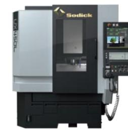
切削工具を超高回転させ、金属素材を3次元形状に加工する機械です。自動交換機能を備えているため、切削、穴あけなど複数の加工が可能です。
