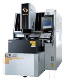
加工したい形状（雄型）を電極にして加工物（雌型）に転写放電して彫り込んでいく加工機械です。導電性加工物の材質や硬さに関係なく、高精度・高品質な加工ができます。
