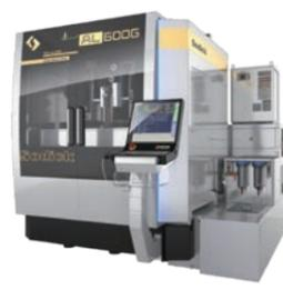
通常 0.03 ~ 0.3 mm のタングステン、真ちゅうなどのワイヤを電極にして、加工物との放電現象により糸鋸のような形状切り抜き加工を高速・高精度に行います。
