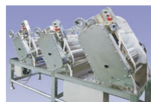
連続圧延機:麺帯のグルテン組織を傷めないよう段階的に圧延
