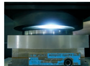
形彫り放電加工をしているスピーカ金型です。
