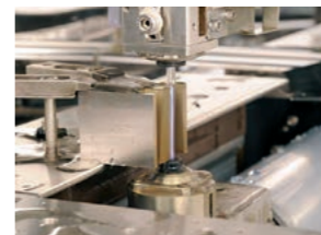
ワイヤ放電加工をしている金属部品です。
