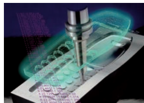
高速直彫り加工をしている携帯電話金型です。
