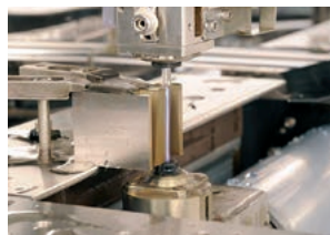
ワイヤ放電加工をしている金属部品です。
