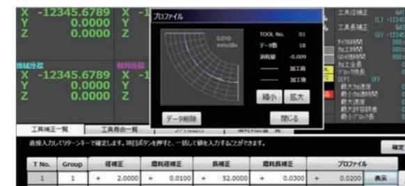
工具の使用状況を管理し、工具交換時に新しい工具を使用することで、高精度・高品質の加工を実現する機能です。
