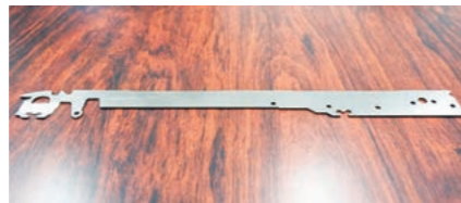
编织横机的控制中必不可少的针板。不断生产的重要零件。
