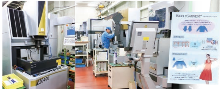
直线电机驱动的线切割放电加工机·电火花放电加工
