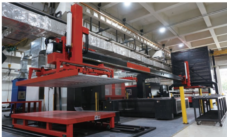
可存放12种不同厚度板材的自动输送机
