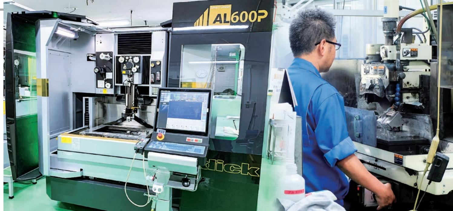
最近引进的间距精度1 μm级电火花线切割机
