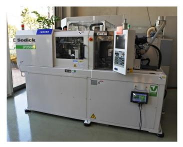
V-LINE<sup>®</sup> 小物精密部品専用 高応答射出成形機「LP20EH3」
