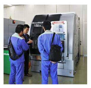
リニアモータ駆動 ウルトラハイスピードミーリングセンタ 「UH430L」
