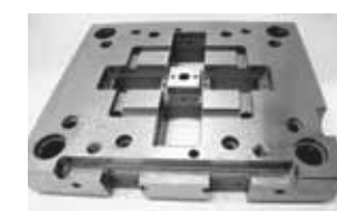
S55C生材 3日間加工→5日間水中浸漬「サビレス」加工事例
