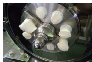
挤出机:通过高真空挤压实现新口感
