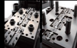
适用于窄间距连接器的精密连续冲压模具
