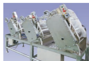
面带连续压延机:会缓慢地连续压延,以免损伤面带的面筋结构。
