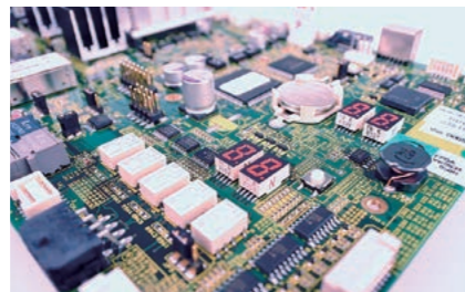
自主开发制造的用于数控装置的印刷电路板
