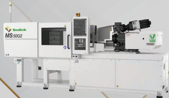
eV-LINE® 电动机型 MS50G2 柱塞直径 22 mm 螺杆直径 22 mm
