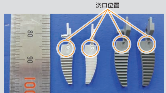
烧结制品 (SUS630) 成型体 (收缩率：13.8%左右)
