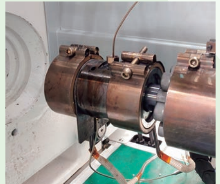
只需拆下注塑机的喷嘴， 换上 Nendy-E 即可
