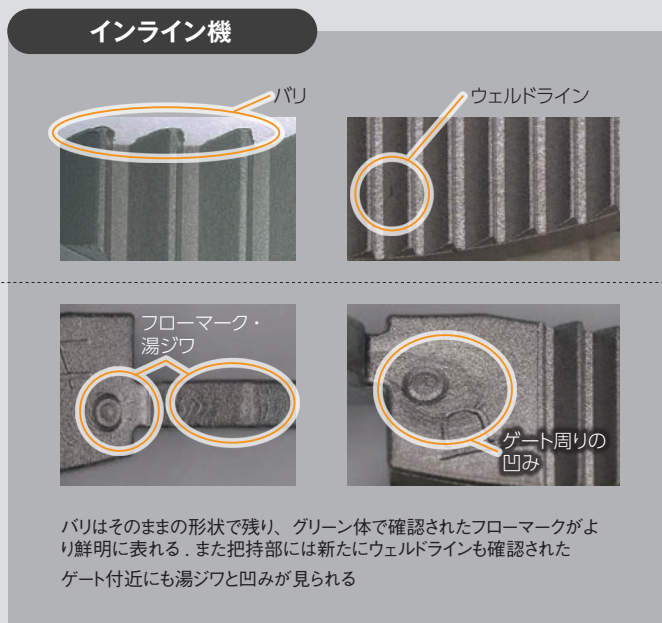
焼結品 (SUS630) 成形体 (収縮率: 13.8% 程度)
