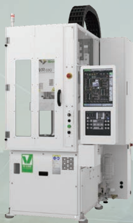
VR03G ブランジャ直径 8、12 mm スクリュ直径 14 mm
