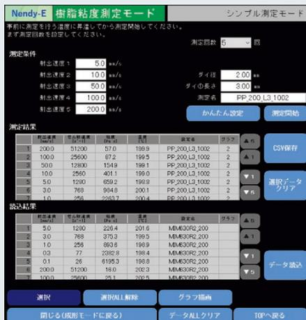
成形機の操作画面で、速度、使用するダイ径などを設定します。『かんたん設定』を押下すると、ダイ径に合った推奨の速度設定が自動入力されるので、誰でも簡単に測定がはじめられます。手動で任意に入力することもできます。
