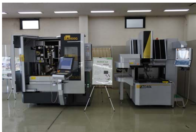
放電加工機紹介コーナー リニアモータ駆動 高速・高性能ワイヤ放電加工機「AL400G」(左) 高速・高性能形彫り放電加工機「AG40L」(右)
