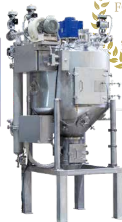
▲ 業界初、環境温度に影響されることなく粉粒体の温度管理が可能な「粉粒体急速冷却装置」
