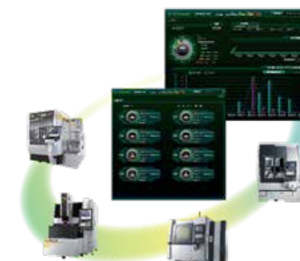
一定間隔で各NC装置を巡回し、データを収集するソフトウェア「S-Viewer」
