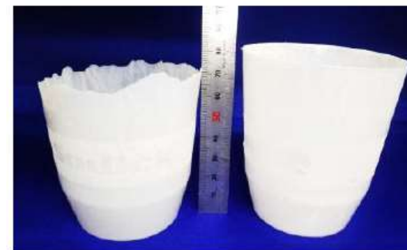
写真 1. 左：標準成形 右：「INFILT-V」使用
