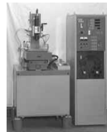
第3世代型(1976) :NC放電加工
