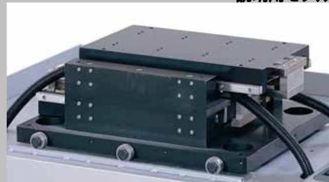
エネルギー相殺 ツインリアモータ駆動 説明用モデル
