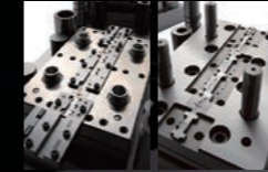
狭ピッチコネクタ用 精密微細順送プレス金型
