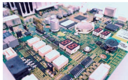
自社開発・製造のNC装置用プリント基板
