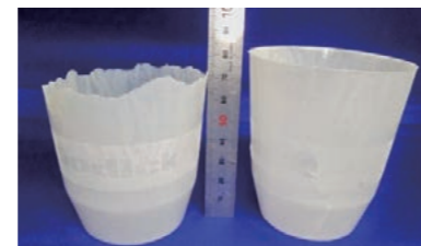
従来の射出成形機(左)とINFILT-V搭載の射出成形機(右)で成形したプラスチックカップの比較
