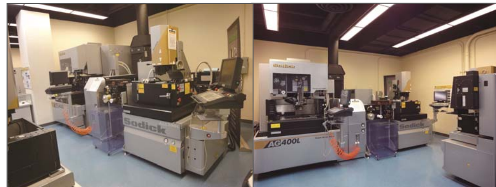
バークレー校PMCに設備された当社の設備 横型ワイヤ放電加工機ASX300L(左)と形彫り放電加工機AG400L(右)
